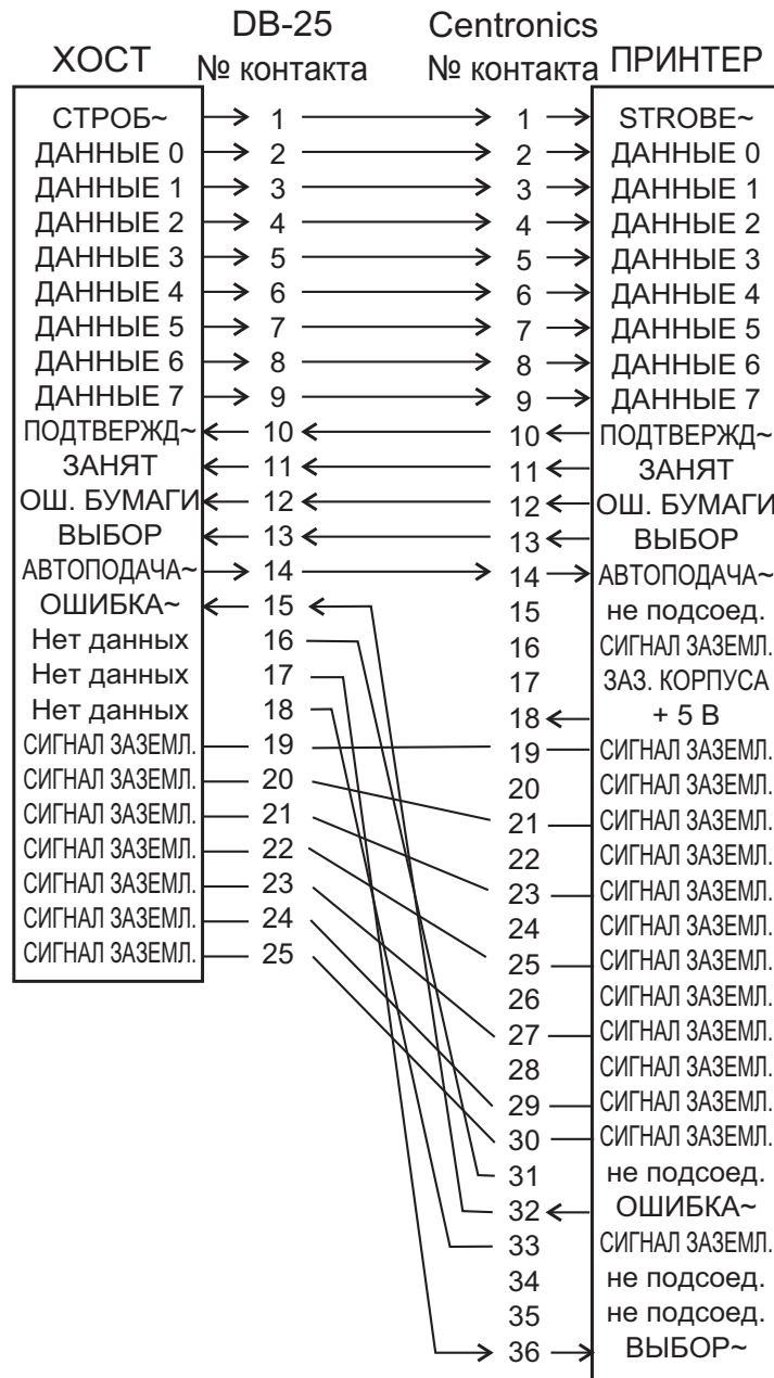
Кабель с разъемами DB-25 и Centronics
