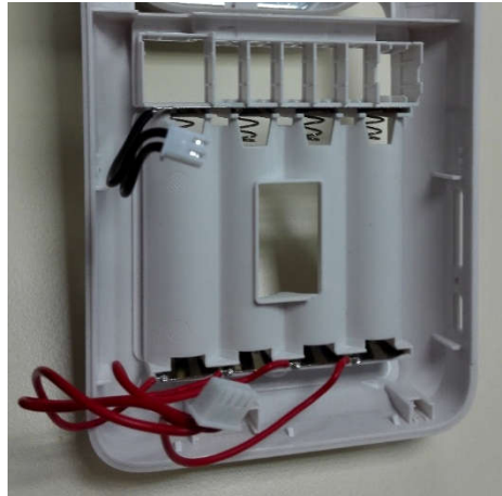
Рисунок 33. Демонтаж контактных групп «+» и «-».
