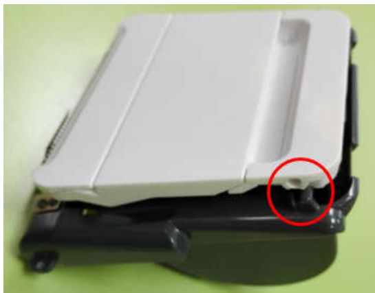
Рисунок 59. Установка крышки лотка.
