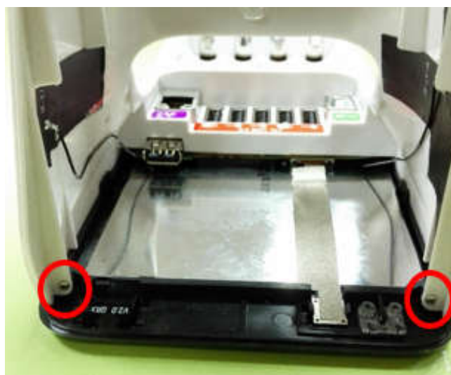
Рисунок 54. Винты крепления корпуса СТ и рамки сенсорного экрана.
