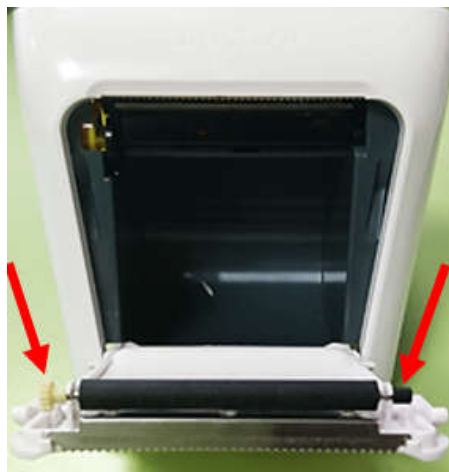
Рисунок 60. Установка прижимного вала.
