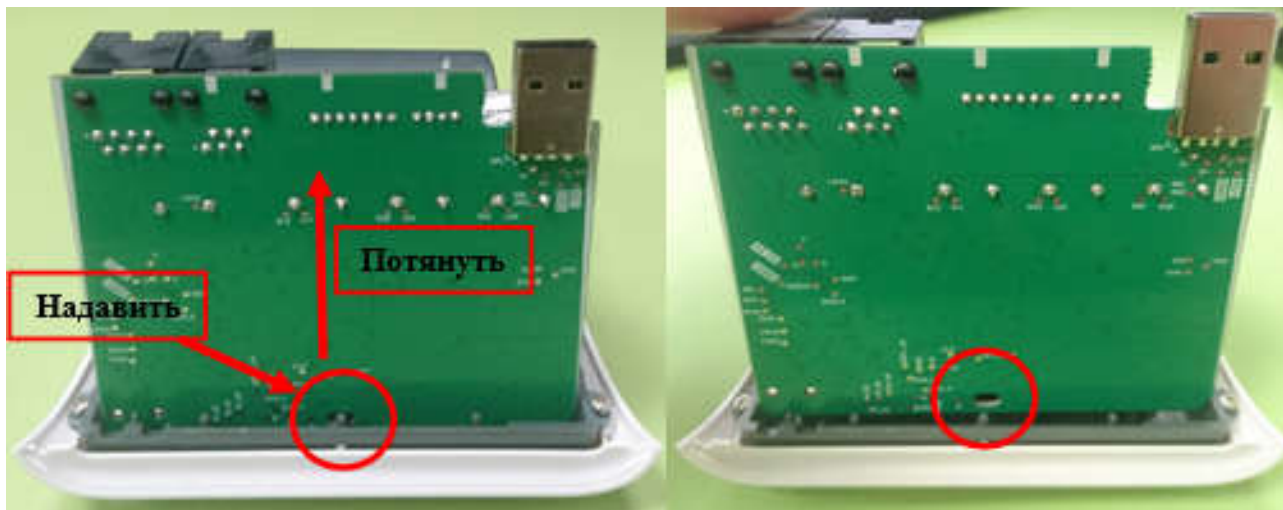
Рисунок 16. Демонтаж модуля ФР.
