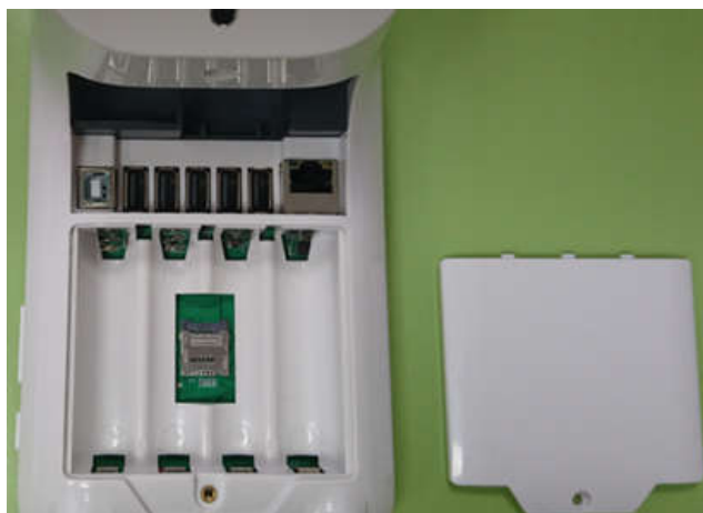
Рисунок 12. Извлечение аккумуляторов из батарейного отсека СТ.
