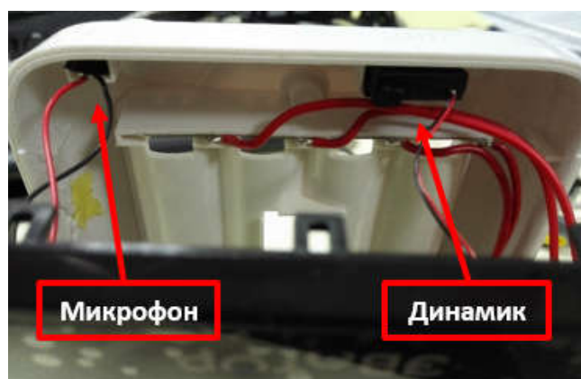
Рисунок 53. Установка микрофона и динамика.
