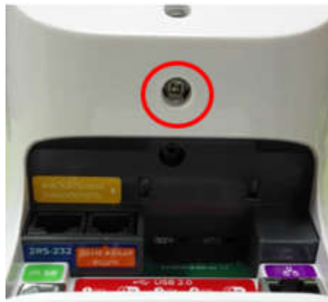
Рисунок 57. Винт крепления корпуса ФР и корпуса СТ.
