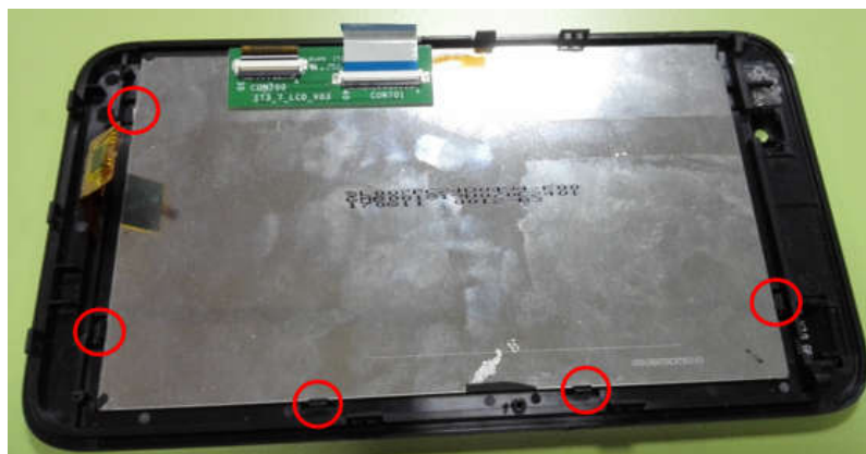
Рисунок 40. Фиксаторы дисплея на рамке сенсорного экрана.
