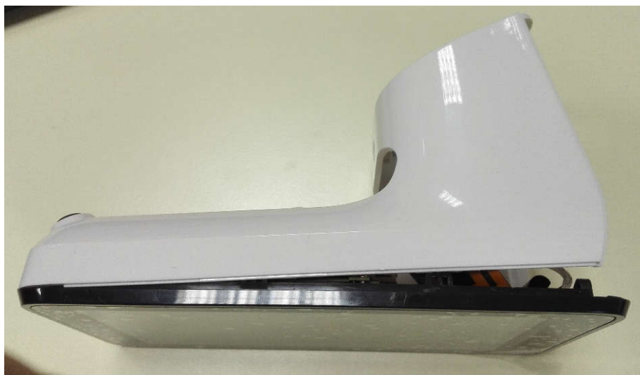
Рисунок 30. Раскрытие корпуса СТ.
