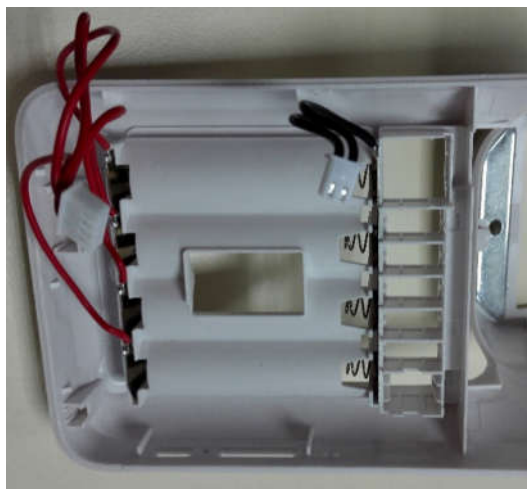
Рисунок 50. Монтаж контактных групп в пазы корпуса СТ.
