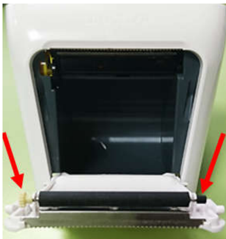
Рисунок 20. Демонтаж прижимного вала ТПМ.
