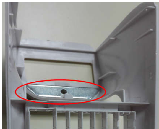
Рисунок 49. Монтаж пластины к корпусу СТ.
