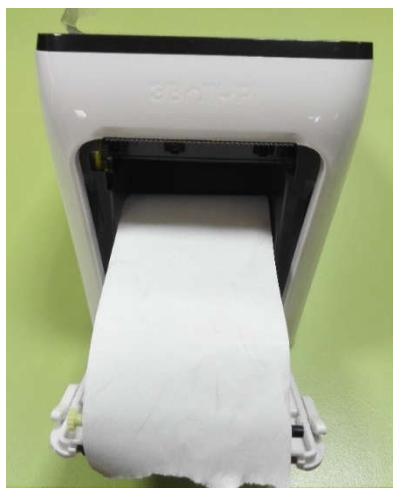
Рисунок 13. Извлечение чековой ленты.
