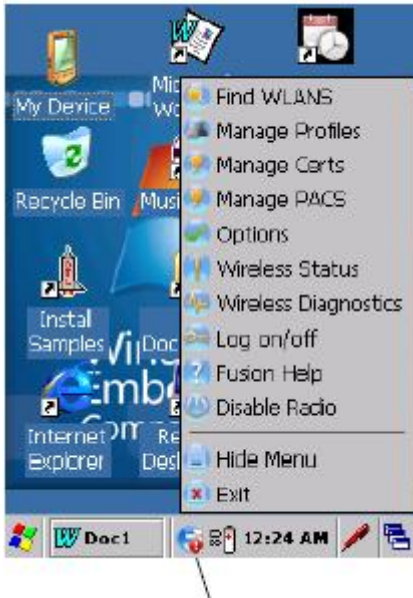
Значок Мощность Сигнала
