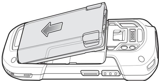
2. Разместите верхнюю часть аккумулятора в отсеке аккумулятора.
