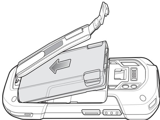
4. Разместите верхнюю часть аккумулятора в отсеке аккумулятора.
