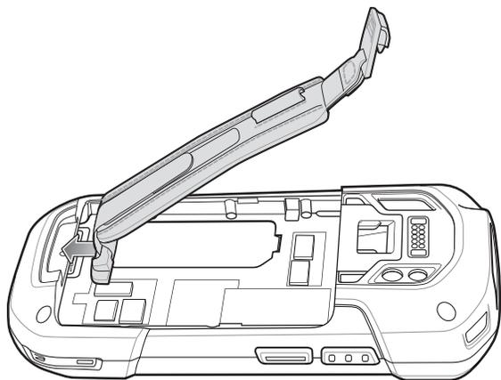
3. Установите нижнюю часть аккумулятора в отсек для аккумулятора на задней устройства.
