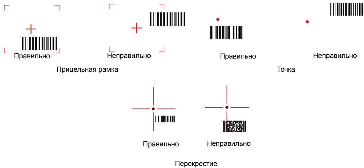
Рис. 2-27 Рамка наведения преобразователя изображения: отсутствие центровки на штрих-коде
